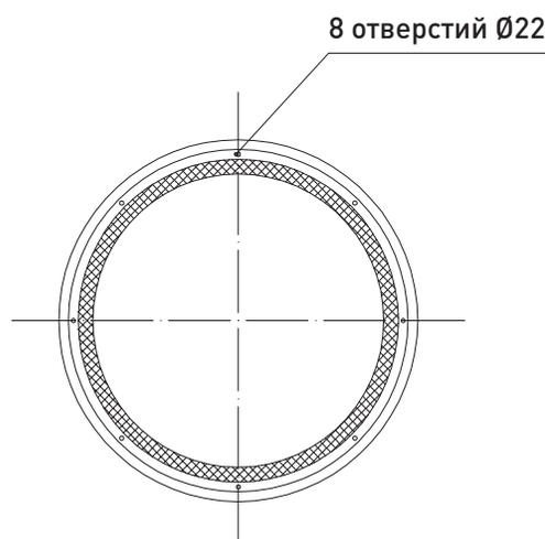
Для монтажа колодца  $\varnothing 2000$  на опорную плиту, необходимо анкерные болты закреплять через трубу усиления  $\varnothing 50$
