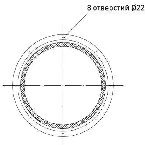
Для монтажа колодца диаметром  $> \varnothing 1000$  на опорную плиту, необходимо анкерные болты закреплять через юбку колодца
