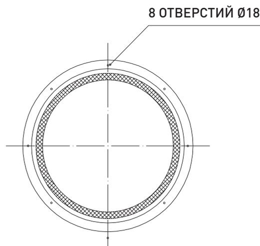
Для монтажа колодца диаметром  $\leq \varnothing 1000$  на опорную плиту, необходимо анкерные болты закреплять через юбку колодца
